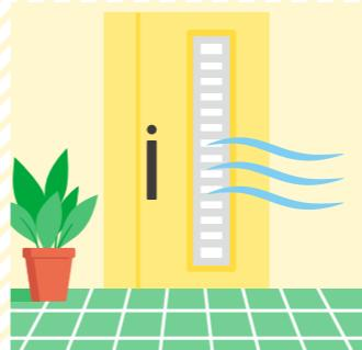
ドアを閉めて施錠したままでも室内に風を取り込むことができる窓付きのドア。「採風ドア」のほか「通風ドア」と呼ばれることもあります。採風ドアを取り入れることで風の通り道を作ることができるので、玄関に置いてある靴のニオいやジメジメした湿気を排出して、新鮮な空気を入れられるのが大きな魅力です。採風ドアは、窓に格子が付いており、人が侵入したり手を入れたりできない構造になっているのでセキュリティ面でも安心。窓には網戸が設置されているので虫の侵入も防いでくれます。採風ドアは、内開きの横すべり窓が付いたタイプや、室内側の上げ下げ窓が付いたタイプなど、いくつかのスタイルがあるので、使い勝手や好みに応じて選ぶことができます。
